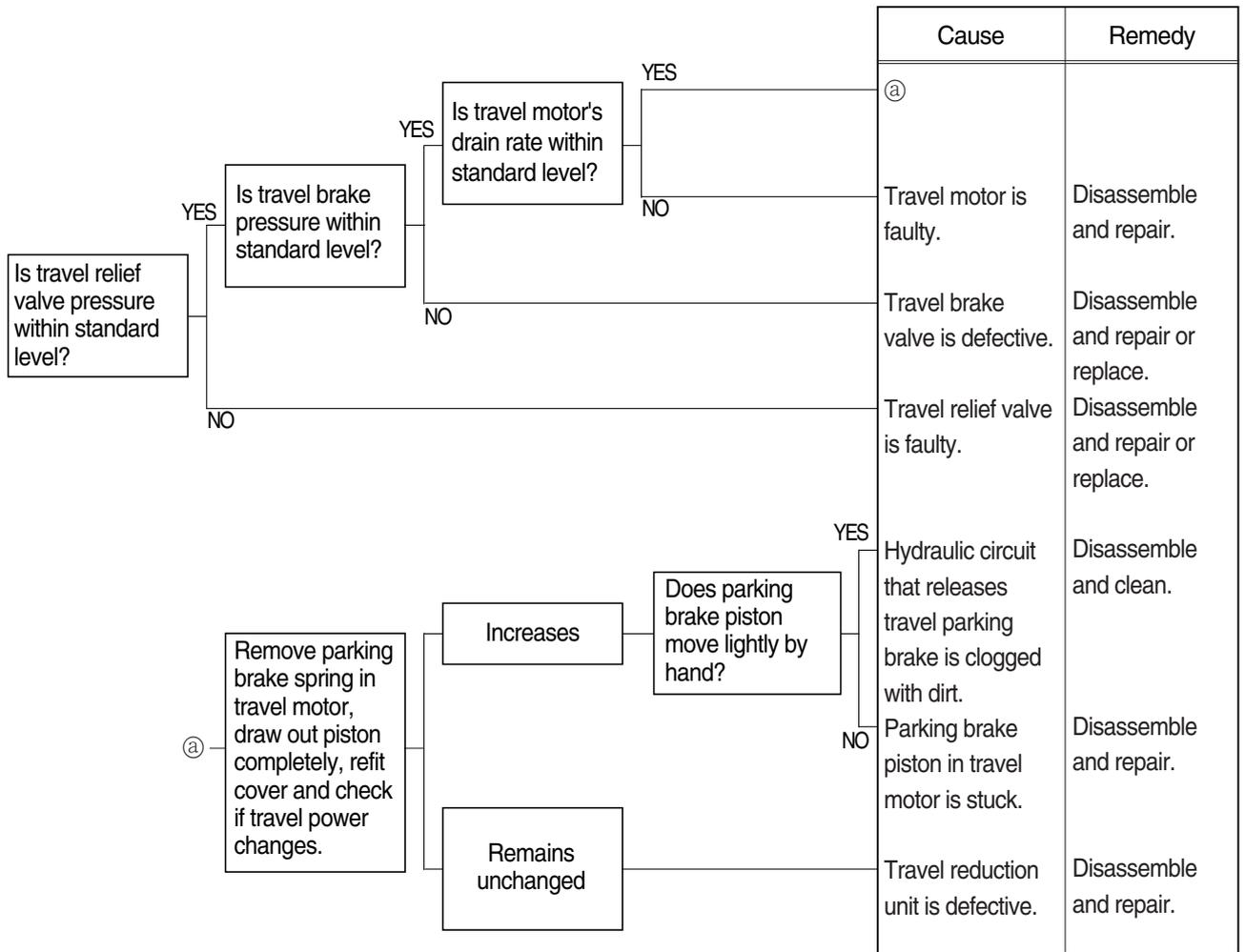
6) MACHINE RUNS RECKLESSLY ON A SLOPE
